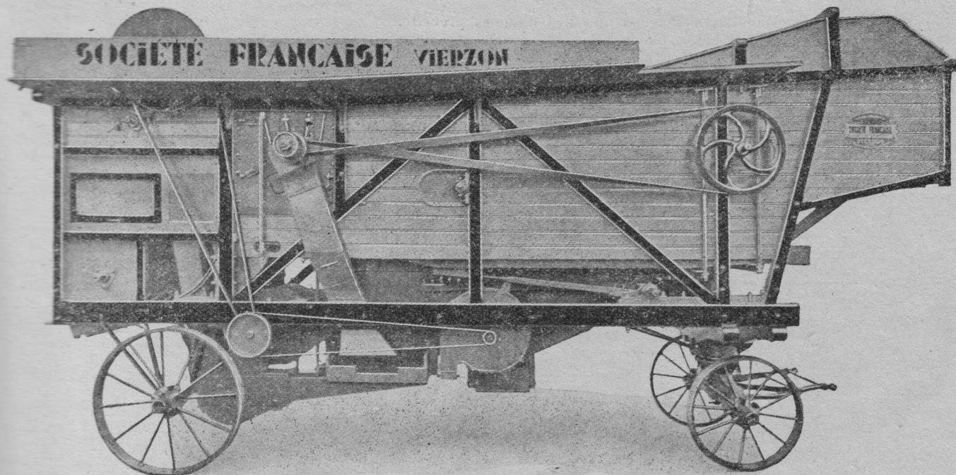
Batteuses en travers pour céréales et légumineuses. — Engrenement par pont sur le côté ou trémie, ou engr. automatique. — Batteur type français. — 8 battes 1/2 rondes cannelées. — Diam. : 650 m/m. — Long. : 1,40 et 1,60 m. — Vitesse : 1.050 T/min. — Contrebattéur acier en 2 pièces avec pitons de réglage. — Secoueurs bois de 4,35 m. — Sasseur à grille persienne, bois, de 0,73 m. — Vitesse de l'arbre des secoueurs : 186 T/Min. — Table zinc ou graepel de 5,09 m. — Double nettoyage.
