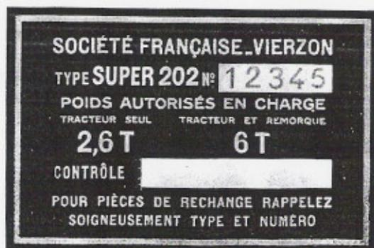
La plaque d'identification du tracteur est rivée sur le côté droit du bâti, un peu au-dessous de l'articulation du frein à pied.
