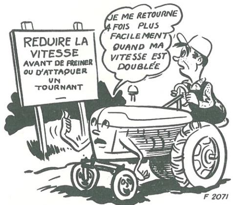
Réduisez la vitesse avant de freiner ou d'attaquer un tournant. N'oubliez pas que les risques de capotage augmentent avec le carré de la vitesse.
