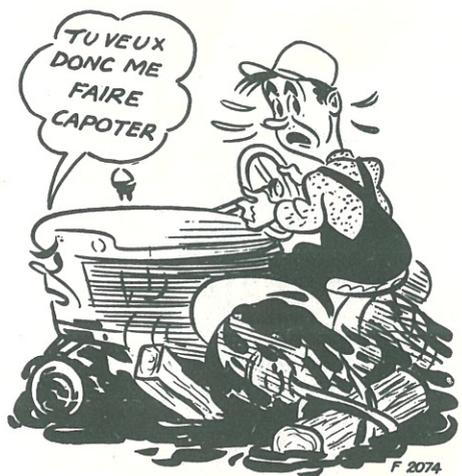
Si le tracteur ne peut se déplacer parce que les roues arrière sont enterrées ou enfoncées profondément dans le terrain, n'attachez pas de bûches, de pierres ou autres objets aux roues arrière pour les empêcher de tourner. Vous êtes certain de capoter .....
