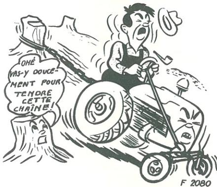
Lorsque vous remorquez une charge avec une chaîne, faites avancer le tracteur lentement jusqu'à ce que le mou de la chaîne soit absorbé.
