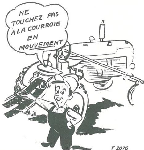
Ne mettez pas en place ou n'enlevez pas la courroie quand la poulie de transmission est en mouvement.
