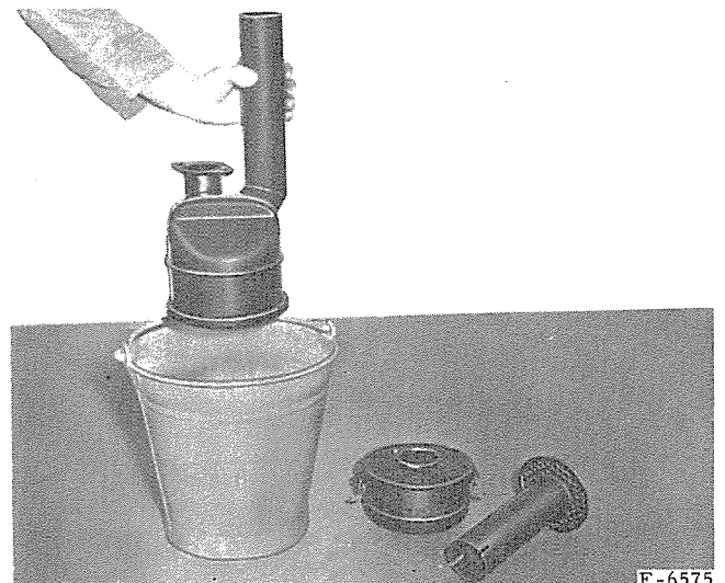
Fig. 34. — Nettoyage du filtre à air dans du gas-oil propre.
