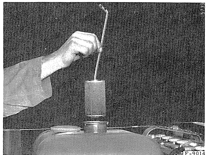
Fig. 52. — Dépose du filtre à combustible.
